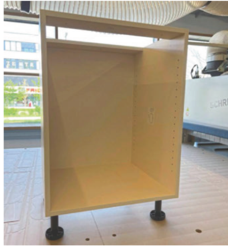
/ Fertig für die Montage: Die bearbeiteten Teile werden mit Verbindungsmitteln versehen und montiert.
