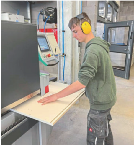
/ Nach der CNC geht es ab an die Kante: Das Etikett gibt vor, welches Material angefahren werden soll.
