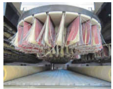
Drehrichtung umschaltbar: Zwei Körnungen auf einem Aggregat ersparen einen Wechsel
