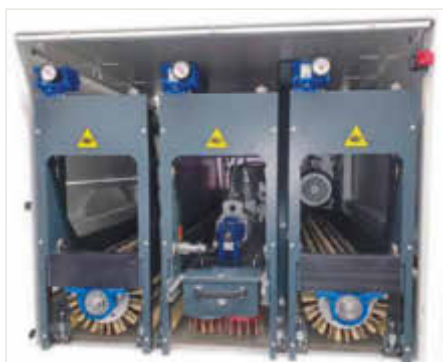
Effizienz durch modularen Aufbau: Zur Wahl stehen 3 oder 5 Längs- bzw. Tellerbürsten
