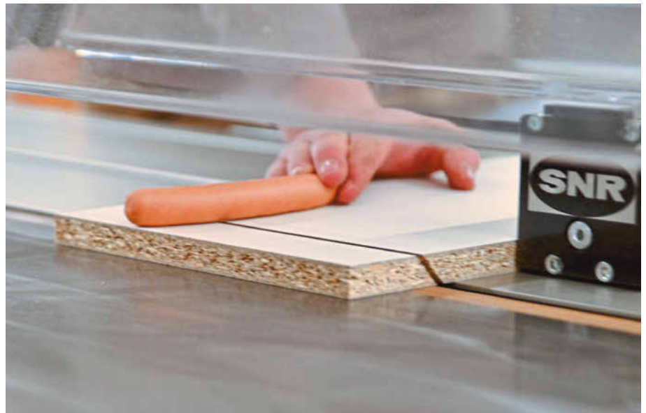
Plötzlich taucht das Sägeblatt schlagartig ab und bleibt stehen. Der Finger ist gerettet
