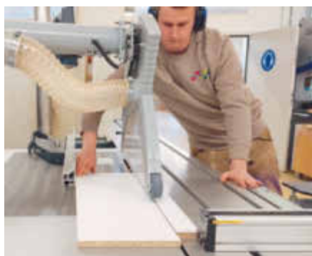
Till Rasch schneidet am Parallelanschlag. Trotz PCS hält er 12 cm Abstand zum Blatt
