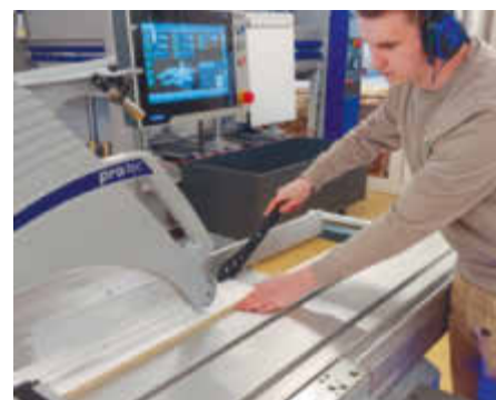
Den schmalen Streifen schneidet er mit dem Schiebestock. PCS setzt nicht ein
