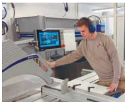
Auch den Zugriff auf die Haube wertet PCS nicht als Gefahrensituation
