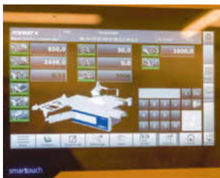
Über diesen Steuerungsbildschirm lassen sich nahezu alle Einstellungen vornehmen
