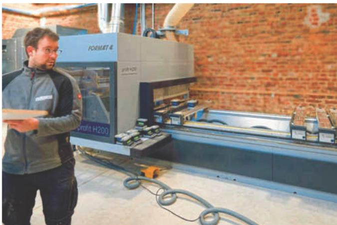
Zuerst fräst er die kleinen Teile und muss dafür die Sauger nicht versetzen
