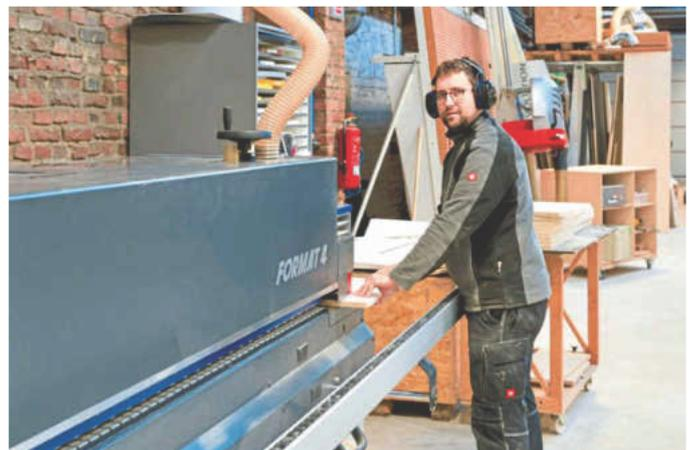
Die Maschine fräst an der Fügestation vom Werkstück exakt die Kantenbanddicke weg
