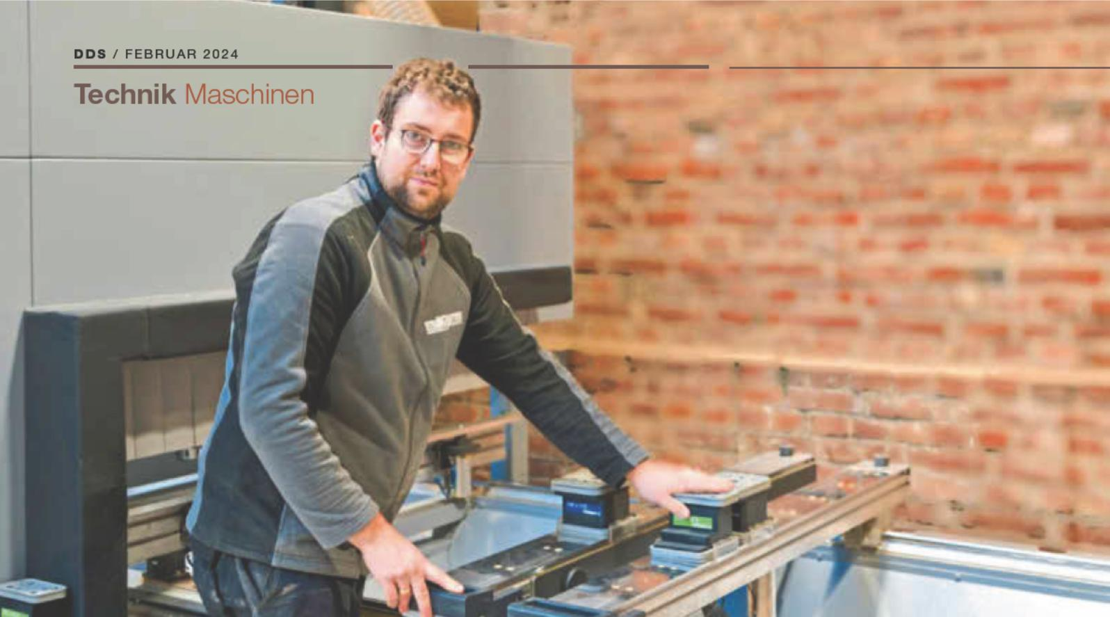
Die Positionierhilfe für die Sauger nutzt Simon Wesseler nur bei Freiformteilen
