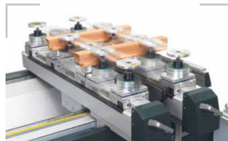
/ Die Komplettbearbeitung von Fenster- und Türrahmen-teilen ermöglicht die automatische „S-Motion“-Konsole.
