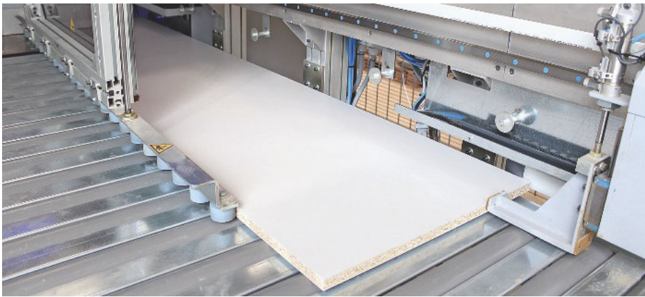
/ Ein Schlüssel für die Automatisierung: Vor dem Einzug in die Durchlauf-CNC Creator 950 werden die Teile am Maschineneinlauf exakt positioniert und vermessen.
