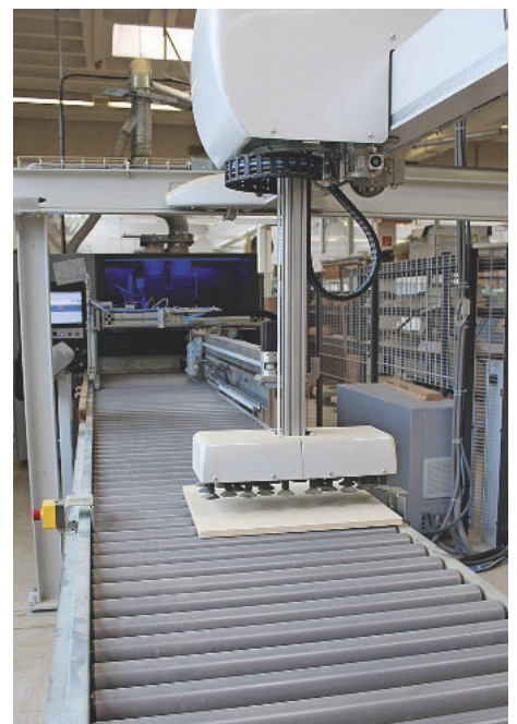
/ Ab in die Maschine: Der Manipulator übergibt die Teile auf die angetriebene Rollenbahn zur CNC.
