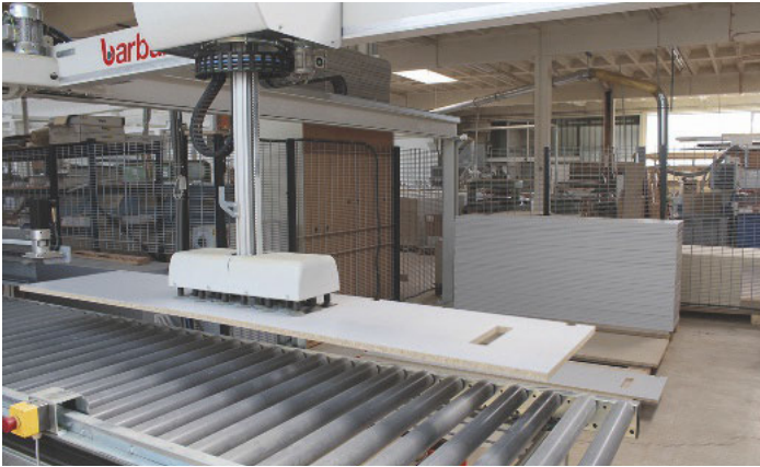
/ Ganz ohne Muskelkraft auch am Ende des Bearbeitungsprozesses: Eine komplett bearbeitete Schranktüre wird automatisch abgestapelt.
