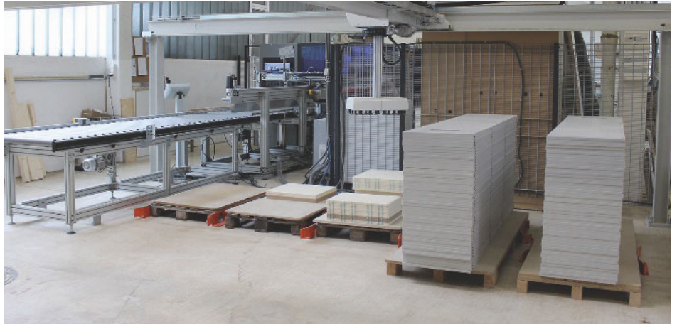
/ Produziert bis zu 12 Stunden völlig autonom, auch nach Feierabend: Die Durchlauf-CNC Creator 950 Format 4 mit vollautomatischer Beschickung und Abstapelung.
