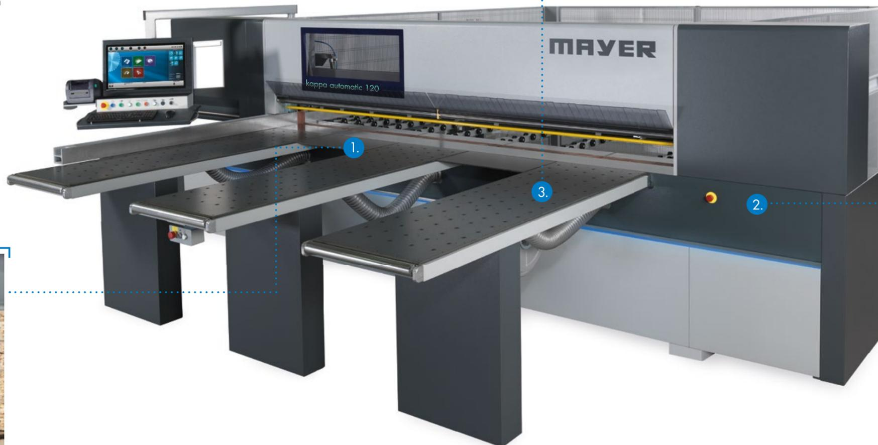
Massive Luftkissentische erleichtern die schonende Bearbeitung von schweren Werkstücken.
