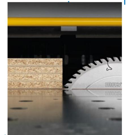
Automatische Schnittlängeneinstellung mit Lasersensor-Erkennung.
