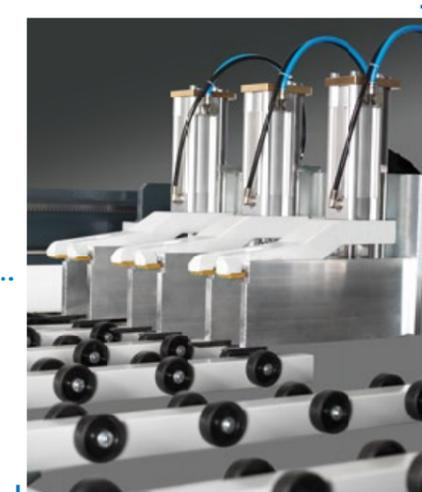
Paketklemmer in Doppelfingerausführung mit variabler Druckeinstellung.
